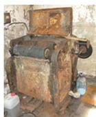
**Мездрение.** Главная его цель заключается в снятии с предварительно отмоченной шкуры мездры, остатков жира и мяса и излишней толщины шкурок, чтобы в дальнейшем при выделке рабочие растворы пикеля и дубителя могли свободно проникнуть в кожную ткань. После мездрения шкурка становится мягкой, пластичной, значительно ускоряется диффузия в дерму последующих пикельно-дубильных веществ.
